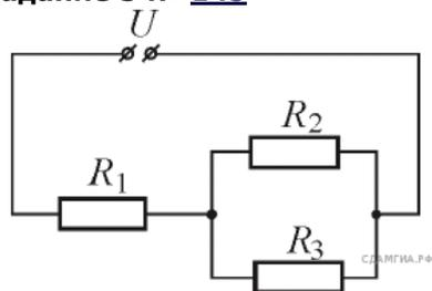
Резисторы  $R_1 = 25$  Ом,  $R_2 = 30$  Ом,  $R_3 = 30$  Ом подключены к источнику постоянного напряжения  $U = 120$  В так, как показано на рисунке. Какая мощность выделяется в резисторе  $R_1$ ? *Ответ запишите в ваттах.*
